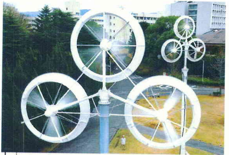
外枠をつけると発電量が増え騒音は減る（福岡県春日市）＝写真 小高顕
