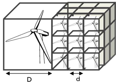
同面積、同定格のシングル風車とマルチ風車
