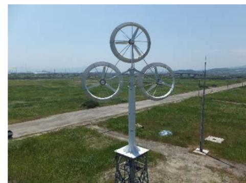
9kW マルチレンズ風車の野外実験: 設置面積は3連の風車幅(8.6m)をそのまま土地へ反映して約 10m四方が必要。タワーは左図とは違ってモノポール鋼管を利用します。基礎面積 6m 四方必要
